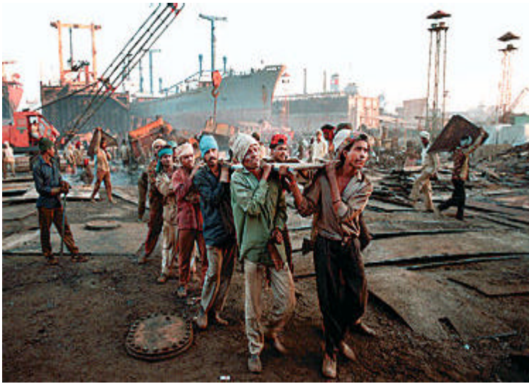
Alang: Abtransport von auseinander gebrannten Teilen .... nur mit Manpower und ohne Handschuhe. Im völlig verdrecktem Strandschlamm können weder Lastfahrzeuge noch mobile Kräne agieren. Wachtürme, eingezäunte Plots und Ausgangskontrollen runden das Bild.
